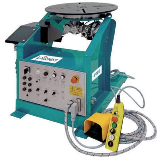
Rotación por motor de corriente alterna con inverter (I), reductor de tornillo sin fin y rangua de bolas. Inclinación con motor eléctrico (E). Instalación eléctrica conforme a las normas CEI EN-60204-1. I: inverter. Pedal (marcha-parada) con cable 5m. Botonera con cable 5m
