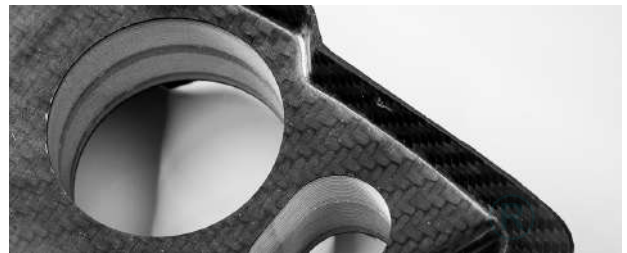
Comparación de mecanizados: seco (izquierda), con lubricante refrigerante especial rhenus (derecha)
