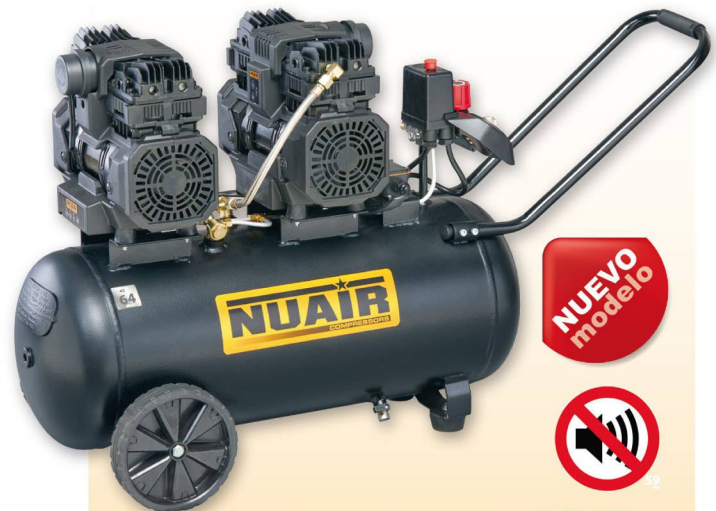
SILTEK TB 50D 3 hp caldera 50 lts. 320 lts./min. 230VII 64 dB (A). 8 bar. Sin aceite.
