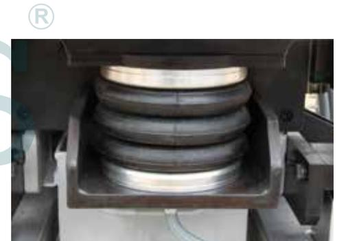
Sistema neumático para fijar el material.
