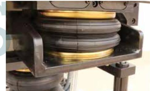
Sistema neumático para fijar el material.
