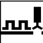
E' uno start pulsato utile per ottimizzare la fase iniziale della saldatura. Consente di unire due lamiere in minore tempo rispetto alla saldatura tradizionale anche se le stesse non sono perfettamente appoggiate tra loro.
