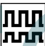
E' un nuovo sistema di saldatura doppio pulsato, che abbina al normale periodo di corrente pulsata un sotto periodo regolabile in tempo percentuale ed ampiezza che permette di far pulsare la corrente di saldatura su quattro livelli anziché i due tradizionali.
