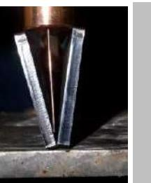
L'ottimizzazione del controllo e della stabilità dell'arco permette di lavorare con lunghi stick-out quando è necessario saldare in posizioni particolari (come V-shape).
