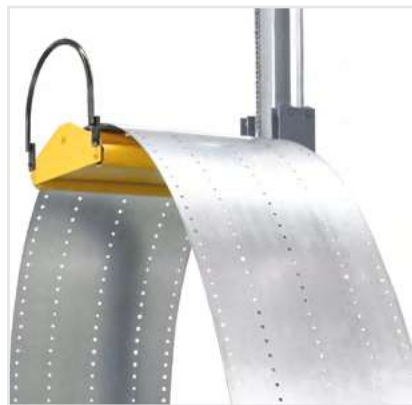
Almacén vertical de chapa (pulmón) Este sistema anula la necesidad de foso (según espesores y anchura de chapa), contribuyendo a un funcionamiento de la línea sin parada.
